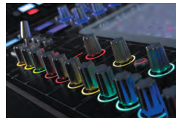
HTL (Hidden Till Lit) ※SD12、SD5、SD7に搭載 フルカラーLEDでチャンネルを簡単に識別。
