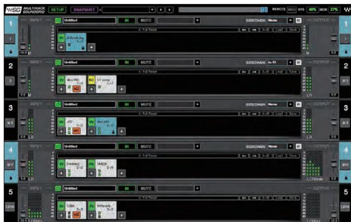
■ DiGiCoコンソールには、オプションでWaves社のプラグインテクノロジー“Waves SoundGrid”に対応できるアップグレードキットを用意。専用のプロセッシングサーバーと接続し、Waves社の豊富なプラグインエフェクトを使用できます。
