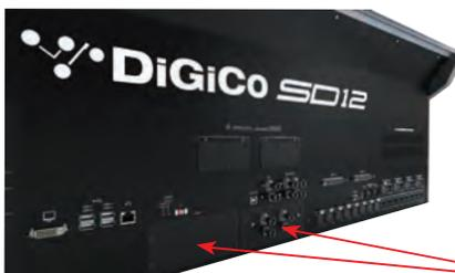
■ オプションで入出力拡張用のDMI (DiGiCo Multichannel Interface) カードを用意しています。任意のフォーマットに変換する多様なカードを用意しており、I/Oラックへの接続や用途に合わせて選択可能です。背面のDMIカード用のスロットに入れて使用します。
