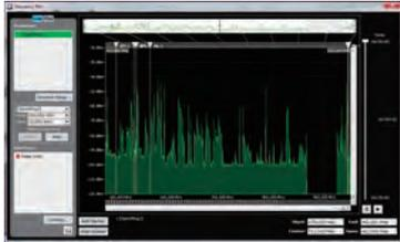
ソフトウェア上で使用する機材や運用する周波数帯域、同時利用チャンネル数を設定すれば、TVチャンネルや現場の電波状況をスキャンし、最適な周波数チャンネルを選出。決定したチャンネルは赤外線経由でボタン1つ押すだけで送信機へ転送できます。
