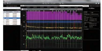
リハーサル時や本番時にWireless Workbench® 6を起動しておけば、運用中の送信機の電波状況をリアルタイムでモニタリング可能。時間軸で状況を把握できるため、外来電波の判別やドロップポイントの特定を高い精度で実行できます。
