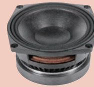
低域ドライバー 5インチ ネオジム磁石採用 1.5インチボイスコイル
