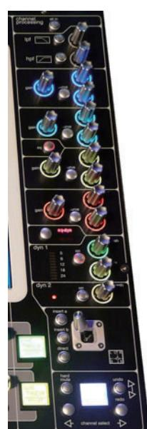
チャンネル・ワークサーフェイス・コントロールの上半分（**insert a**, **insert b**, および **direct** ボタンまで。上図参照）では、アクティブ・チャンネルの該当セクションにタッチすると表示されるポップアップ画面に表示される信号処理パラメーターを操作します。下半分は出力ルーティングに関係しています。
