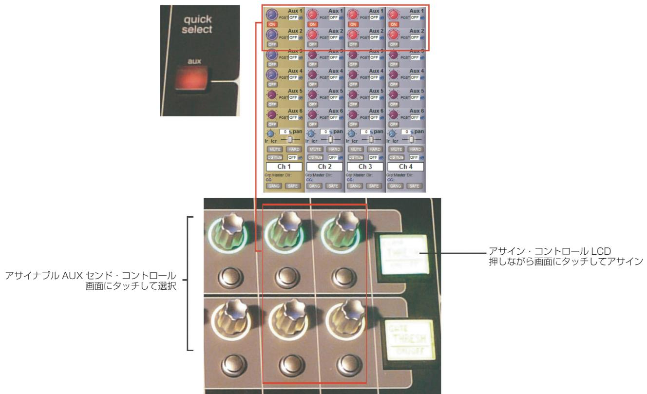
また、チャンネルの全てのAUXセンドを单一画面で表示し、スクリーンの下にある24個のエンコーダーにアサインすることも可能です。それには、表示したいチャンネルの現在アサインされているAUX行にタッチします。画面レイアウトは、各AUXがアサインされているエンコーダーに対応しています。24以上のAUXがある場合、画面スクロール機能を使用してアサインをスクロールします。
