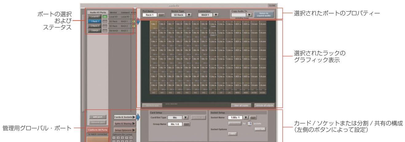
ウィンドウ左上隅にはポートが表示されます。各ポートは、物理音声接続 (Local IO、IO Rack、または MADI Port) に対応しています。ポートは、ウィンドウ左下隅の方にあるボタンを使用して追加 / 削除できます。
