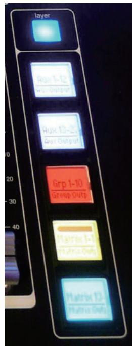
「バンク」は 12 本のフェーダーで構成され、「レイヤー」は最大 5 バンクで構成されています。各セクションに 2 つの「レイヤー」があり、左 / 右のワークサーフェイス・セクションのそれぞれで最大 120 チャンネルにアクセスできるほか、センター・セクションで別の 96 チャンネルにアクセス可能です。
