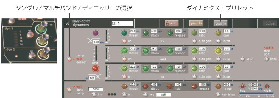
スクリーンの下にあるアサインブル・エンコーダーとスイッチは、任意のメイン・ダイナミクス・コントロールにアサインできます。入力セクションの左側にある「Assign Switch」ボタンを押しながら、画面上の必要なダイナミクス・コントロールにタッチします。選択したコントロールは、「Status Display」によって表示されます。
