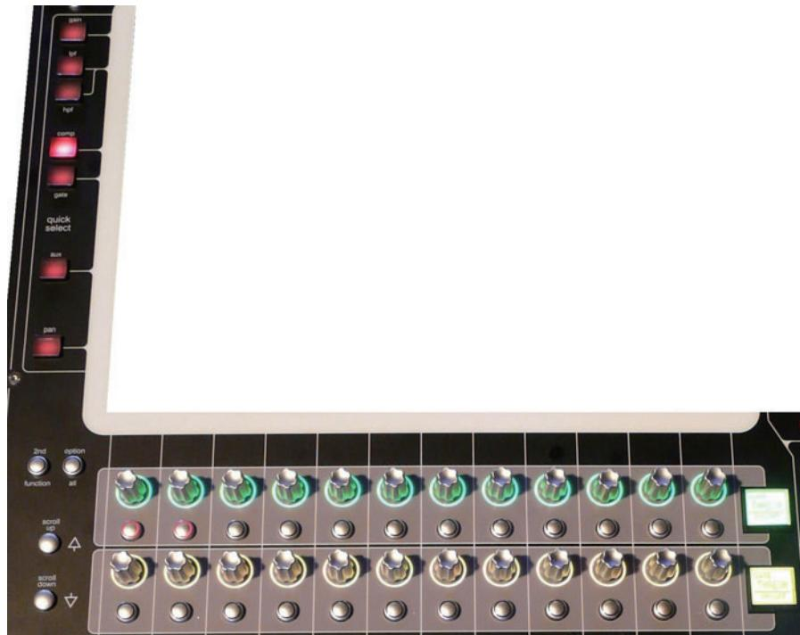
タッチスクリーンのすぐ下に2列に並んだ12個のエンコーダーとボタン（上図参照）は、その位置にあるチャンネルに対応します。スクリーンの左側にある**quick select**ボタンのいずれかを押すと、選択されている機能がこれらのコントロールの上列にアサインされます。「Channel Strip」パネルには6つのAUXセンドを同時に表示できます。セッションで7つ以上のAUXセンドを作成した場合、スクリーン左下隅の外側にあるスクロール・ボタンを使用すると残りのAUXをスクロールして表示できます。
