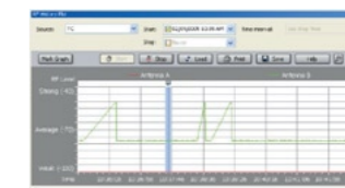
<電波受信状況表示例> 電波強度と時間軸の2次元グラフで表示。
