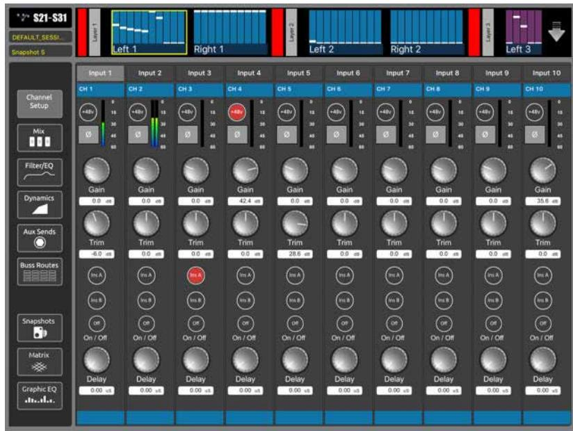
「CHANNEL SETUP」画面には +48V、ポラリティ (極性)、ゲイン (アナログ)、トリム (デジタル)、チャンネル・ディレイ、インサート・ポイント ON/OFF、およびメーターが表示されます。
