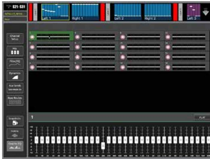
「GRAPHIC EQ」画面には各ユニットの 32 本のフェーダーおよび ON/OFF ボタンに加え、選択中のユニットの全バンド・リセット・ボタンが表示されます。
