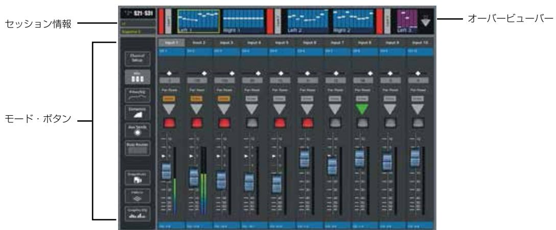
オーバービューバーの右端にある下向きの矢印にタッチするとビューが開き、全てのコンソール・バンクが表示されます。
