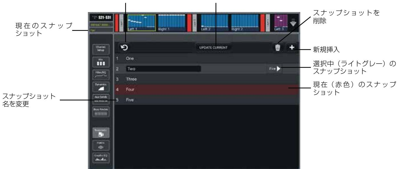
「SNAPSHOT」画面ではスナップショットの Insert New( 新規挿入 )、Recall( 呼び出し )、Undo( 取り消し )、Update( 更新 )、Rename( 名前変更 )、Delete( 削除 ) 操作を行えます。
