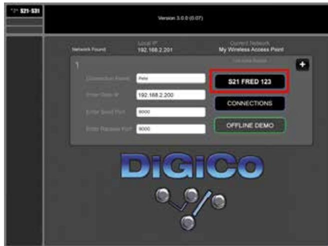
有効な接続が確立されると、接続リストに項目が自動作成されます。「CONNECTIONS」ボタンにタッチし、リストからその接続を選択することにより、後で呼び出すことができます。
