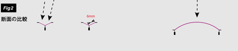
Fig2 はそれぞれのダイアフラムの断面を示しています。 CODA AUDIOのリングダイアフラムの幅は、一般的なダイアフラムに比べると狭く、この例では6mmとなります。
