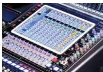
15インチタッチスクリーン フェーダーに対応する12系統を表示。
