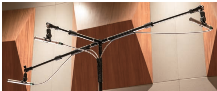
IO-VECTOR と、IO-A1A × 1、IO-A2A × 2、M2 × 3、CABLE CONTROL を組み合わせた Decca Tree 収音例
