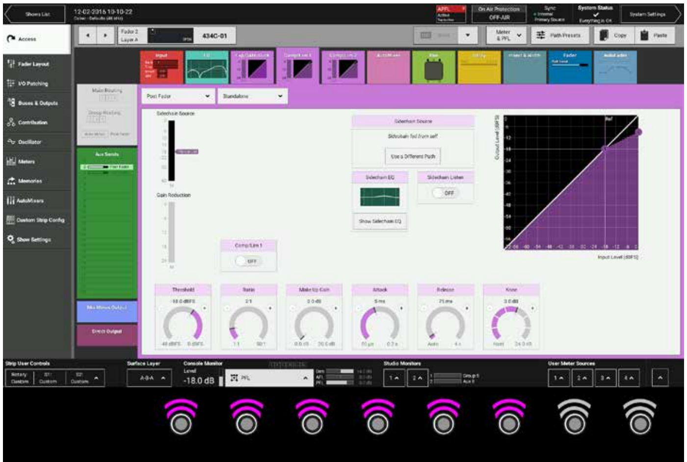
図4 - コンプレッサー／リミッターコントロール
