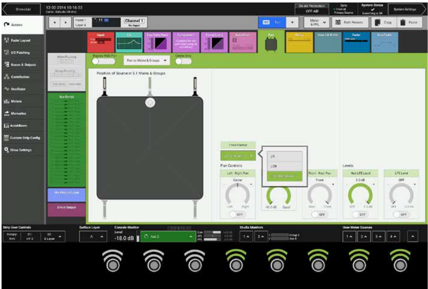
図1 - コンテキスト対応コントローラー - アクセスモード - メイン／グループへのパン
