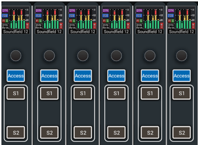
図1 - フェーダーストリップのロータリーコントローラーとユーザーボタン
