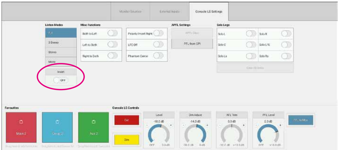
図2 - コンソールモニターインサートON/OFFボタン
