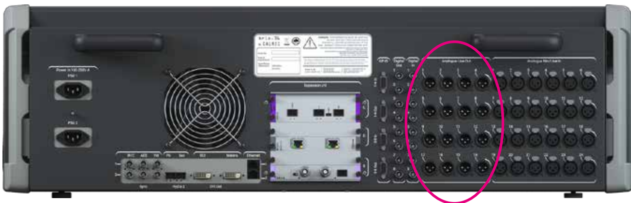
図2 - BRIO 36の背面図 - 内蔵出力ポートの位置
