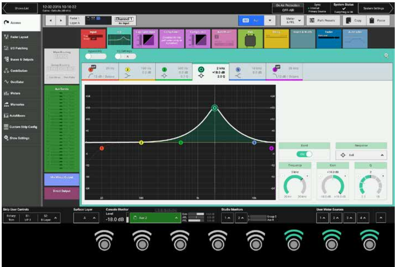
図1 - コンテキスト対応コントローラー - アクセスモード - EQバンド4
