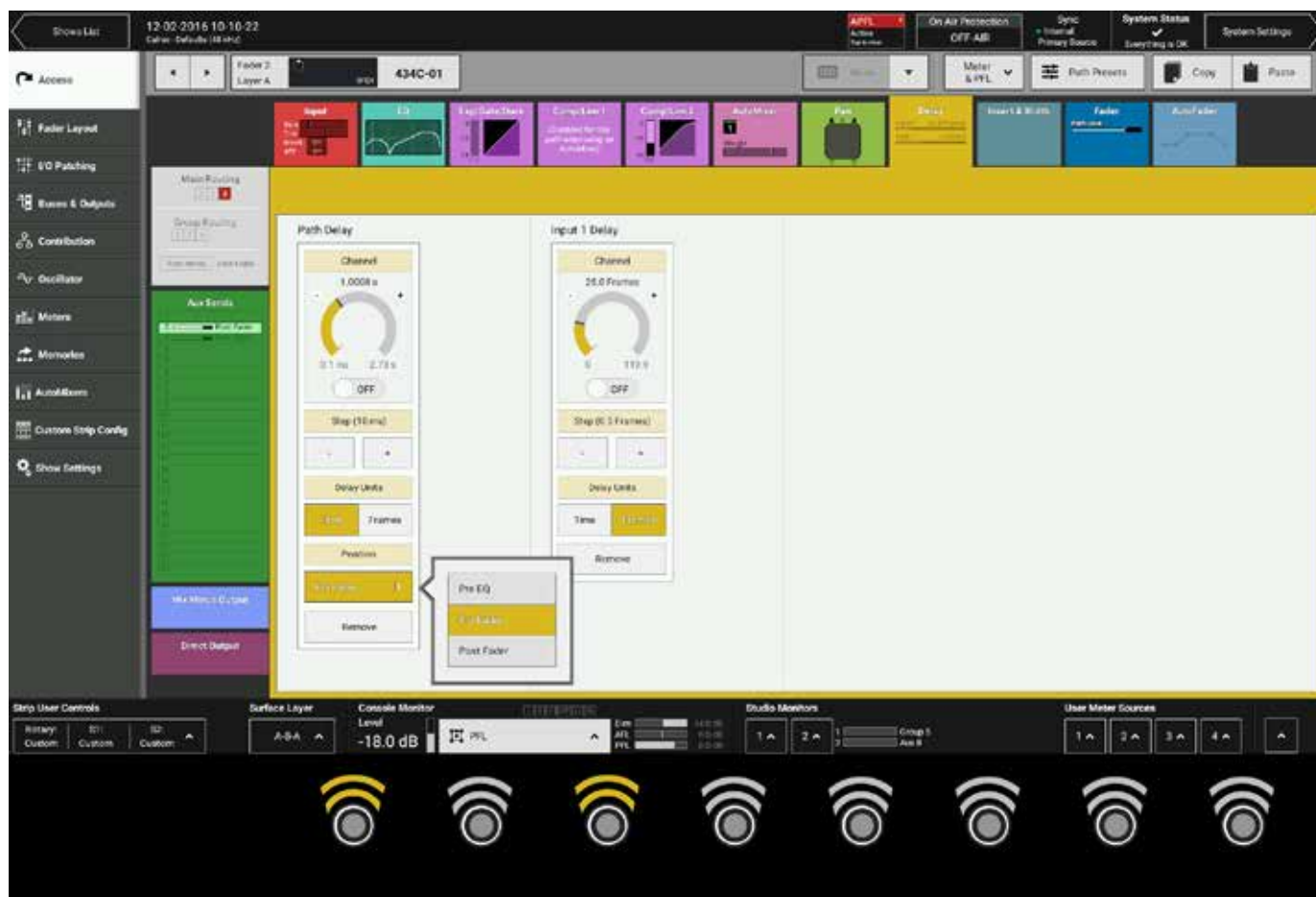
図1 - コンテキスト対応ロータリーコントローラー - 入力/パスディレイコントロール(パン位置を表示した状態)
