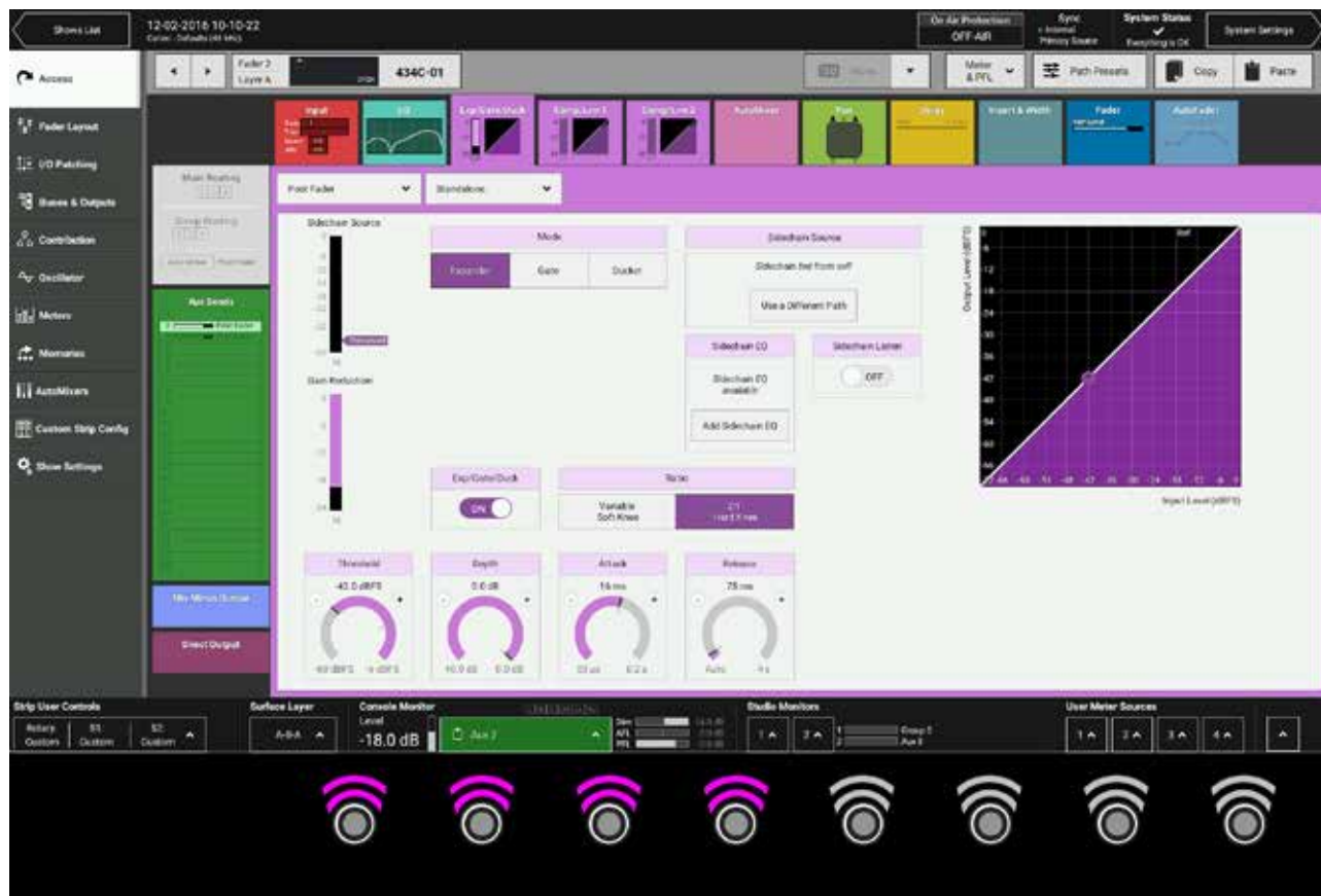
図1 - コンテキスト対応コントローラー - アクセスモード - エクスパンダー／ゲート／ダッカー*
