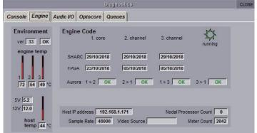
「SHARC」および「FPGA」フィールドに表示される日付は、FPGA 上で実行されているコードです。使用可能日は表示されなくなりました。
