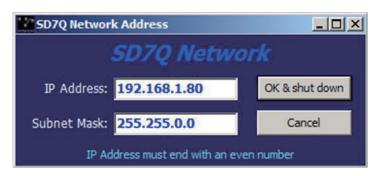
上のプログラムでコンソール PC の IP アドレスとサブネット・マスクを入力できます。ホスト・インターフェース・コントローラーの IP アドレスは、アプリケーションによって正しい連続アドレスに自動設定されます。IP アドレスまたはサブネット・マスクを入力した後、変更を有効にするにはコンソールの電源を入れ直す必要があります。「OK & shut down」ボタンを押すとシャットダウン処理が始まります。
