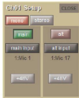
入力チャンネルで利用可能な入力は、外部 I/O ラックからの入力、コンソールの背面にあるローカル入力、それに各種の内部信号です。Setup ディスプレイの main input または alt input ルーティング・スイッチを押すと、Input Route ディスプレイが表示されます。これらのスイッチは選択された時ルーティング方法は「1.6 ルーティングの基本」を参照して行ってください。
