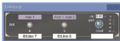
ルーティングパネルを開いた表示の下に白い空欄があり、通常のローディング手順で各 talk バス用のメイン出力と talkback マイクに使用される input の選択を可能にします。ルートは通常の方法で名前を付けることができます。現在のルートはボックス内で表示されます。複数の出力は選択することができ（最初だけ表示されます）、alt 入力を利用可能になります。
