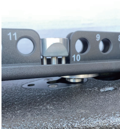
(図 24、図 25 : FRH-APS からキャビネットへの接続ポイント (N-APS 用))
