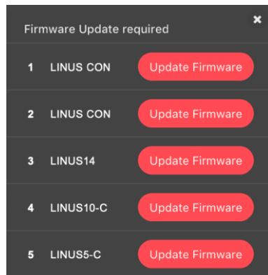
注意) 「Update Firmware」ボタンを押した後、しばらくして再び表示された場合はアンプの電源を入れ直してください。「Update Firmware」ボタンを押した時点で、アンプは検出リストから消えます。アンプが検出リストに表示されるまで30秒以上待ってください。
