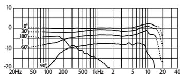
※フロアモニターとの干渉によるハウリングを軽減するため、180°では低域から中域にかけて傾斜しています。
