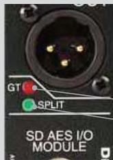
■ 各出力カードには、スプリット機能のON/OFFとゲイントラッキングのON/OFFを示すLEDがついています。
