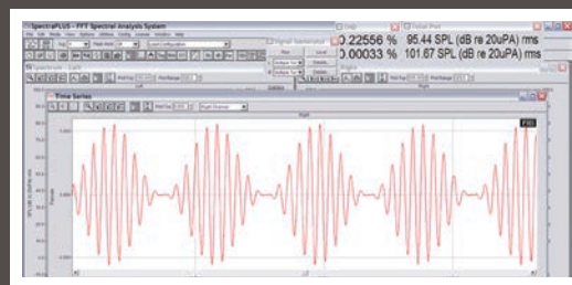
3つの異なる周波数 (第一信号: F=2500\text{Hz} 、第二信号: F_2=F-F/10=2250\text{Hz} 第三信号: F_3=F+F/10=2750\text{Hz} ) のバースト信号を用いた測定結果です。
