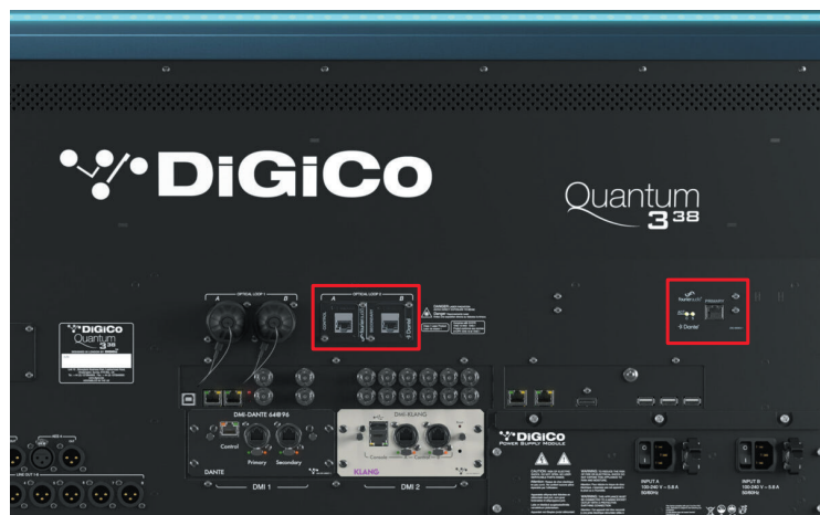
Quantum338の背面に搭載されたFourier Interface Card
