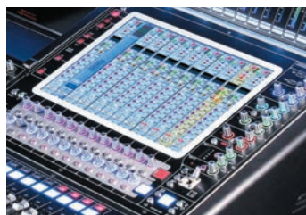
大型のタッチスクリーン フェーダーに対応する12系統を表示。
