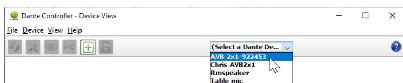
4. Identifyアイコンを選択します。デバイスの応答方法は、それぞれのデバイスに依存します。EasyIPミキサーの場合は、前面パネルのすべてのステータスLEDが点滅します。識別動作を停止するには、Identifyアイコンを再度選択します。
