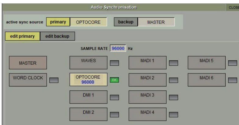
同期クロックを Optocore（96kHz）に設定した場合
