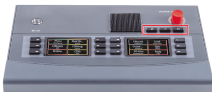
図 40 : DSP-2312 (リセットのキー押し)
