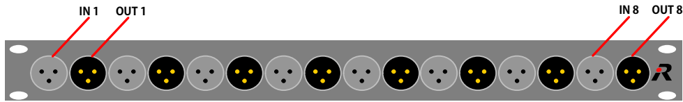
図 192 : XLR パッチフィールド (正面図)
