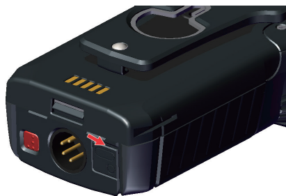
図 183 : 指の爪を差し込む
