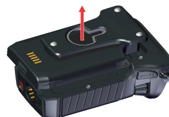
図 190：バッテリーを持ち上げる
