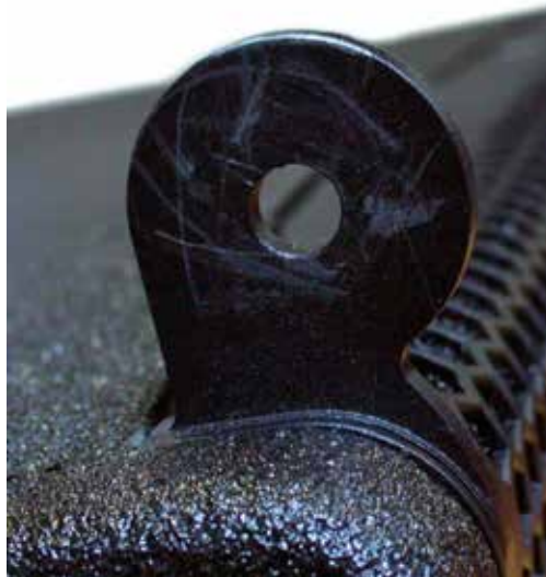
(図 4 何度か使用した AiRAY のキャビネット内部にある連結アーム)
