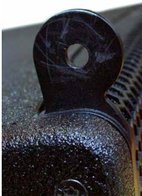
(図 4 何度か使用した TiRAY のキャビネット内部にある連結アーム)
