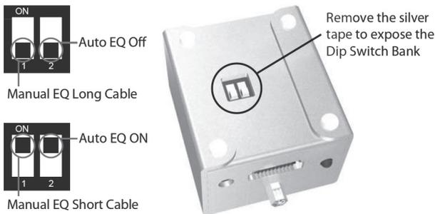
オートイコライジングモードにセットアップするためには、Dipスイッチ2をONの位置にしてください。この場合EQトリムポットを使っての手動調整はできません。Dipスイッチ1はこのモードでは動作しません。もしビデオのノイズが自動EQモードでも続くようであれば、Dipスイッチ2をOFFにしてマニュアルイコライジングモードに戻し、Dipスイッチ1を使用しているケーブルの長さに応じて切り替えてください。(ケーブルの長さは10mを目安として、ロングかショートへ切替えることをお勧めします) EQトリムポットをドライバーなどで左右に動かし画質の調整を行うことができます。
