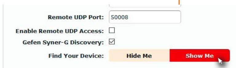
5. ウィンドウ上部に以下のメッセージが表示され、本体フロントパネルの「Power」と「Link」のLED インジケータが同時に点滅を始めます。点滅しているユニットが探していた本体です。
