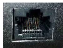
損傷したコネクタ：接触ピンの一部が曲がっていて、ケーブル側コネクタと確実に接触しない
