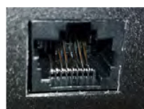
損傷したコネクタ: 接触ピンの一部が曲がっていて、ケーブル側コネクタと確実に接触しない
