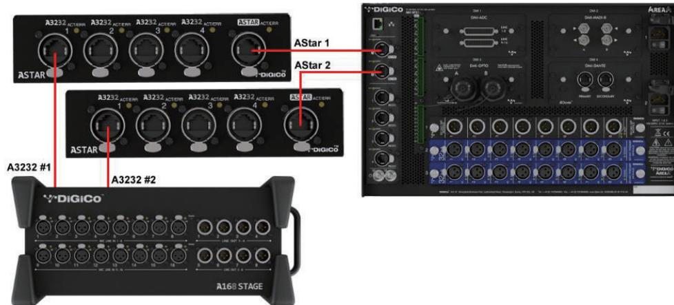
ASTAR の電源を入れ、リンクが確立されると、ASTAR の Lnk/Err インジケータが一定の間隔で点滅します。通信エラーが検出された場合、エラーインジケータが赤く点灯します。ケーブルが正しく接続され、破損していないことを確認してください。
