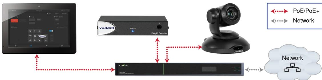
1. CAT-5eケーブルをデバイスコントローラーのネットワーク/PoEポートに接続します。
