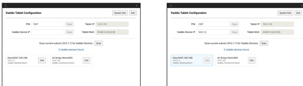
制御する必要があるデバイスのIPアドレスがわかっている場合は、Vaddio Device IPボックスにそのIPアドレスを入力し、Saveボタンをタッチします。
