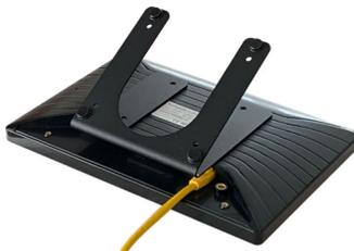
4. CAT5eケーブルの片側を、PoE+スイッチのポートに接続します。
