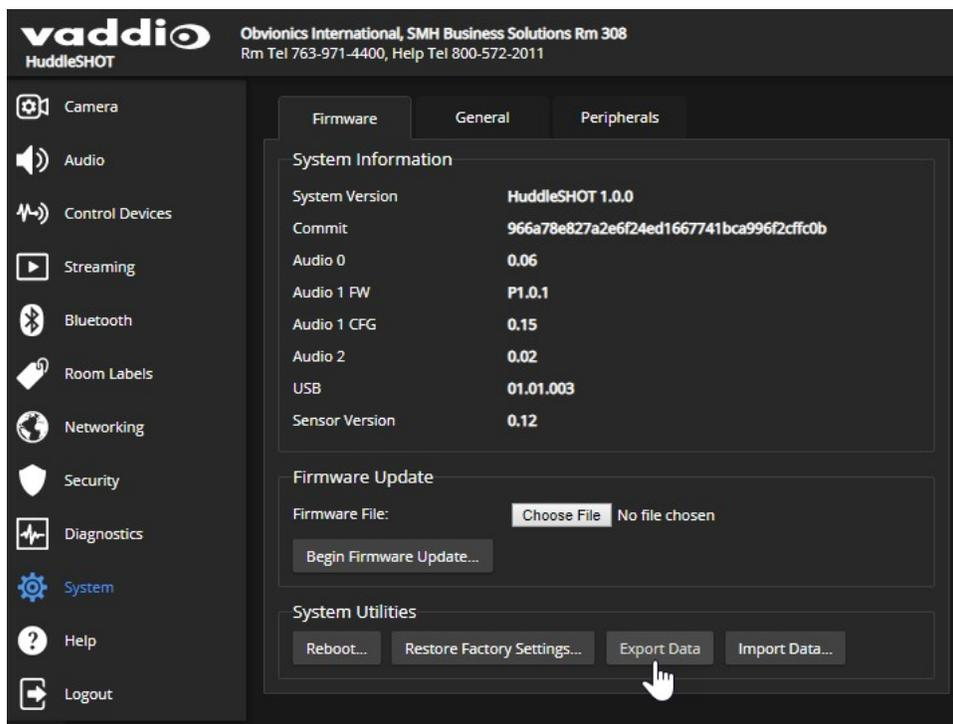
3. 設定を復元する場合は、Import Dataボタンを選択します。Import Dataダイアログが表示されるので、Choose Fileボタンを押してインポートする .datファイルを選択し、Begin Importing Dataボタンを選択します。設定を別のカメラにコピーするには、コピー先のカメラのWebインターフェースからこの手順を実行します。
