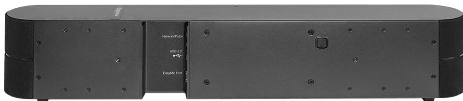
**ネットワーク /PoE+**：RJ-45 コネクタ。PoE+ パワーインジェクターのPower and Data Out ポートに接続します。USB 3.0：USB Type Cコネクタ。会議アプリケーションで使用するコンピューターに接続します。非圧縮 USB 3.0ストリーミングを供給します。
