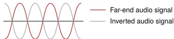
マイクがスピーカーから拾う相手側の音声をキャンセルすることで、相手側音声のフィードバックを防ぎます。
