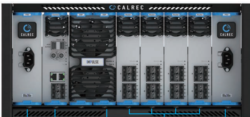
PSUカード コントロール・プロセッサカード DSPカード ルーターカード PSUカード
