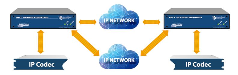
SureStreamerを使用すると既存の伝送システムに追加することでIP回線の冗長化が可能 UDP/RTPプロトコルを使用したコーデックに有効 25Mbpsまでの伝送帯域に対応予定
