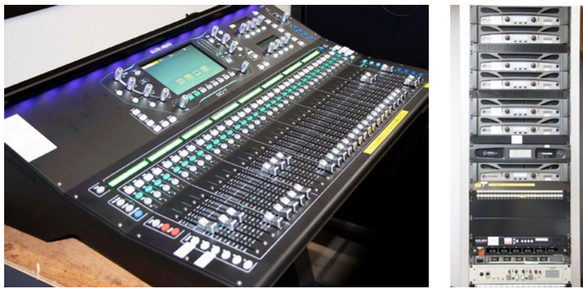
左：SQ-7 右：ラックマウントされた CROWN XTi2002, DCi2|300, ALLEN & HEATH AHM-16
