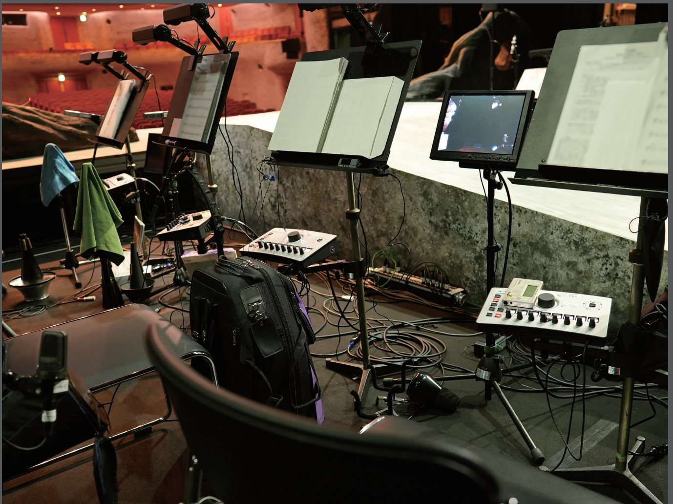
▲ オーケストラピット内、各プレイヤーにセットされた KLANG:technologies 「kontroller」 Strings、Brass、WoodWind、Perc.、Gtr. など合計 22 台が使用されている。
