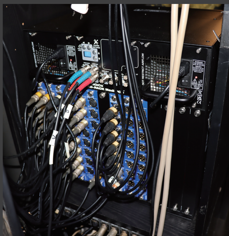
▲ ステージ脇に設置されたI/Oラック「SD-Rack」 32bitの入出力カードを挿入
