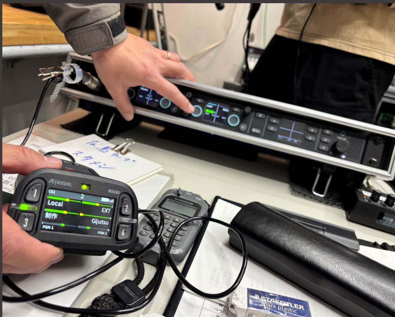
▲ワイヤレスインカム Bolero と有線インカム PunQtum が連動している様子
