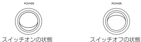
電源スイッチをオンにすると起動し、2-3秒後にアンプが作動し始めます。
